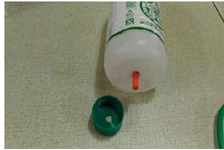
圖 2 罐底及瓶蓋以鑽子打洞。
